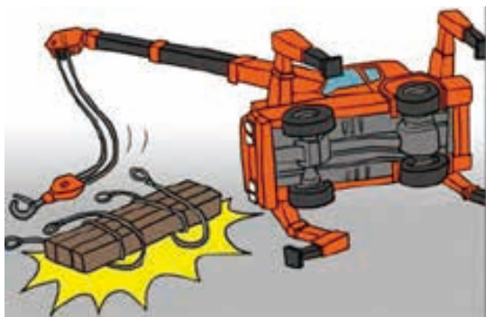
クレーンの転倒
